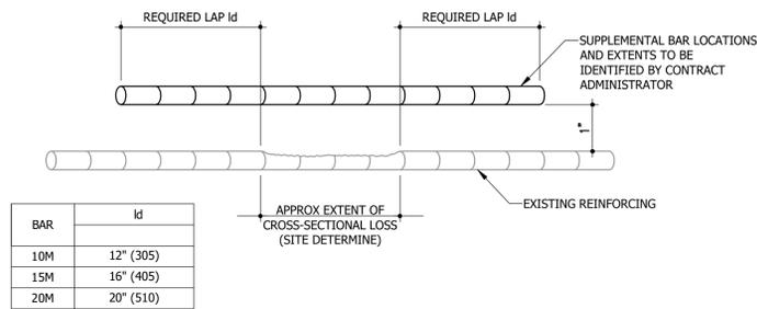
**C** REINFORCING BAR SPLICE DETAIL
